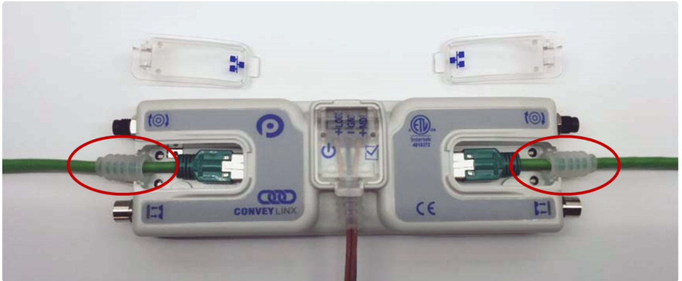
Ai2-Modul mit linkem & rechtem Ethernetkabel (Abdeckungen abgenommen)
