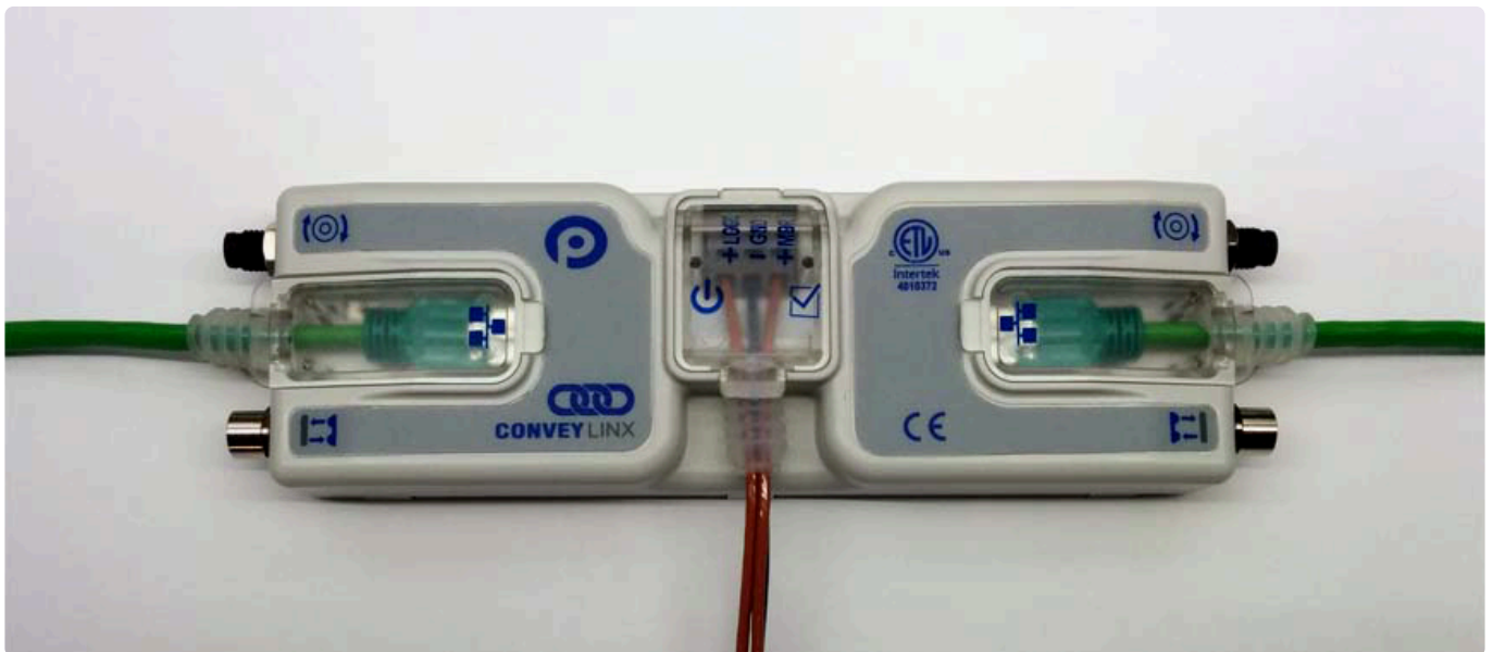
Ai2-Modul mit linkem & rechtem Ethernetkabel mit angebrachten Abdeckungen
