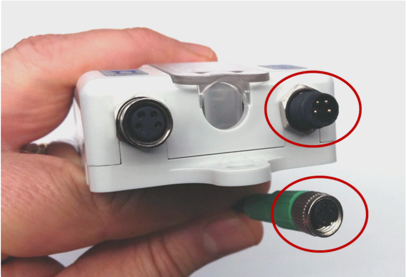
4-poliger M8-Motorstecker mit Senergy Ai-Motorbuchse
