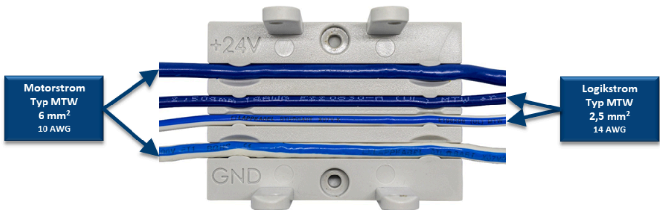
Modulhalterung mit angebrachten Kabeln
